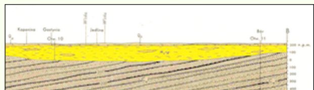
Fig. 5 - Sezione geologica profonda (Servizio Geologico della Polonia, 1955) (Q h : Olocene; Q p : Pleistocene; M ngi : Neogene; C wo : Carbonifero)
