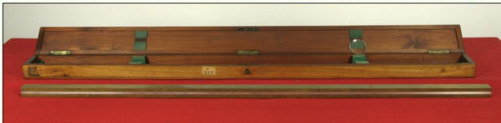
Prototipo del Metro campione del secolo XVIII. Il metro standard fu definito pari alla distanza fra due intaccature su una barra di platino e iridio resistente alla ruggine tenuta in una camera blindata con aria condizionata, nel laboratorio di Pesi e Misure a Sèvres in Francia.
