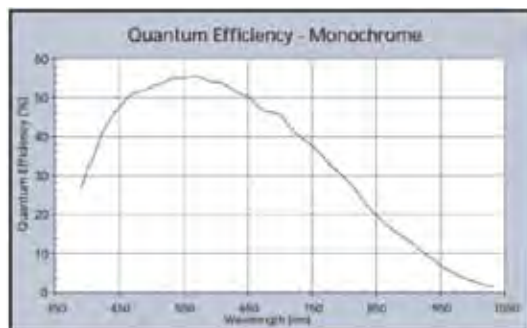
Fig. 23 - Diagramma relativo all'efficienza quantica del sensore Micron MT9M001.
